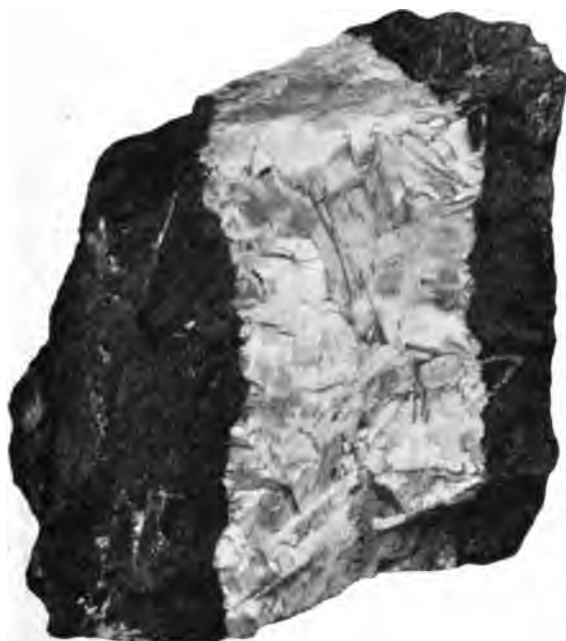
Fig. 5. Symmetrisch-lagenförmige Verwachsung. Kalkspat und Kupferkies. Neu-Adlergang bei Kupferberg i. Schles.
